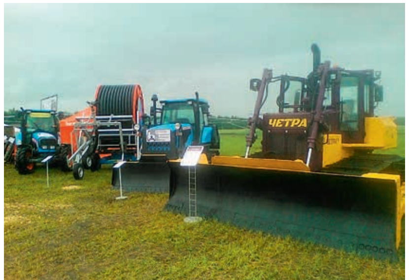
▲ На снимке: бульдозер ЧЕТРА Т9 в мелиоративном исполнении
