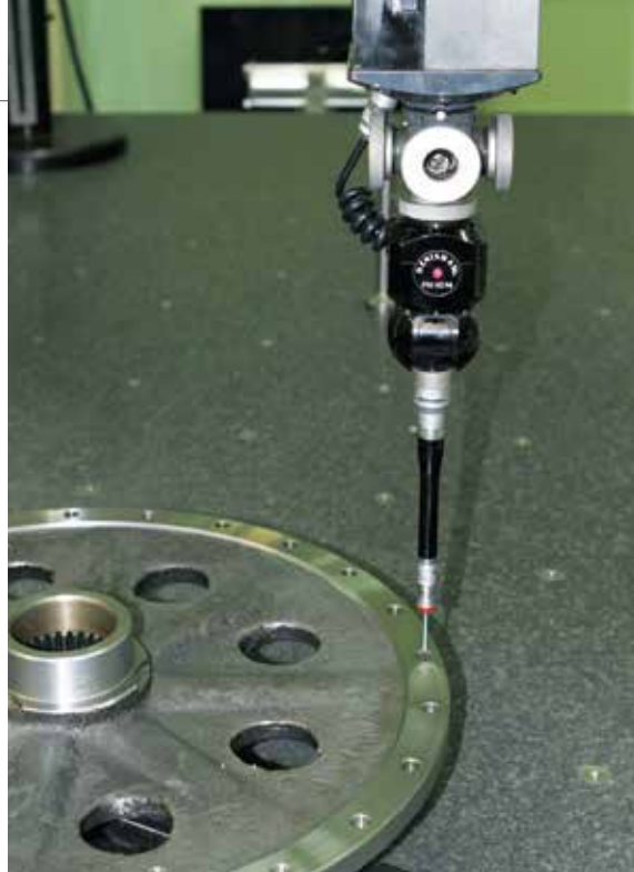
▲ На снимке: замер позиционного допуска ступицы 1101-19-8 производства стороннего предприятия на трехкоординатной измерительной машине
