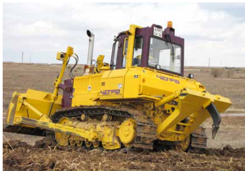
▲ На снимке: бульдозер ЧЕТРА Т9 оснащен гидравлически управляемым отвалом и рыхлителем
