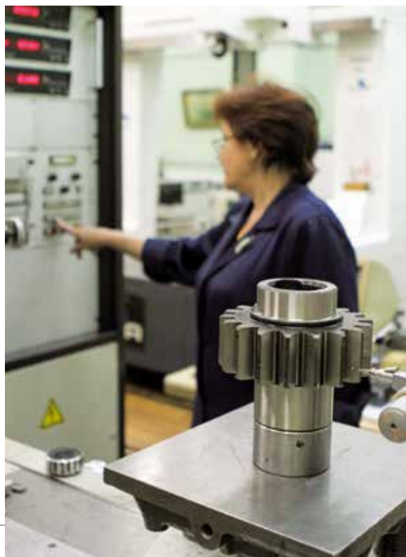
◀ На снимке: замер параметров зубьев неоригинальной шестерни 1101-19-6 при помощи эвольвентомера
