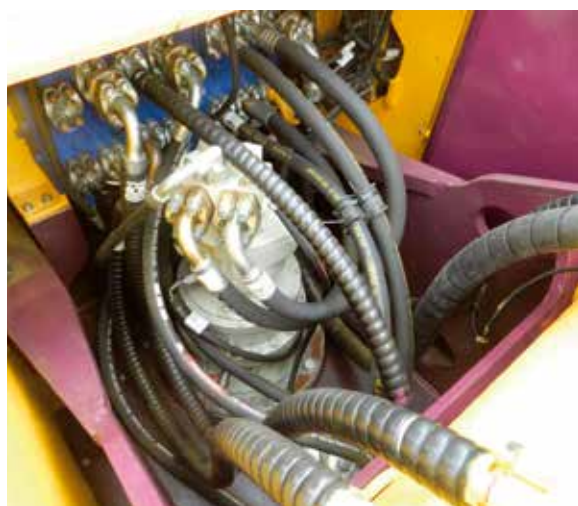
← На снимках: привод поворота платформы экскаватора (слева); привод хода Bosch Rexroth установлены на всей линейке экскаваторов ЧЕТРА ЭГП (справа)
