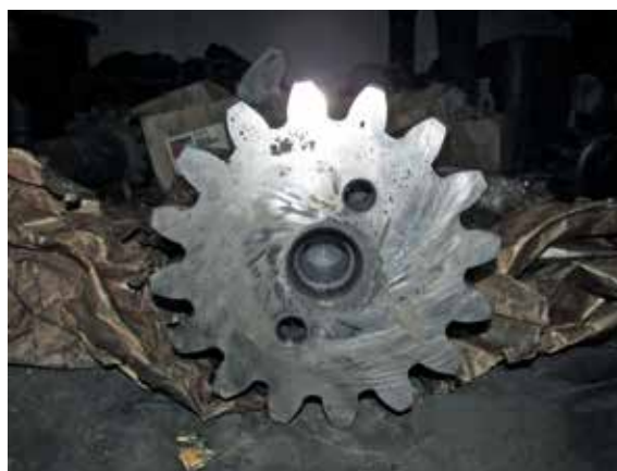
▲ На снимках: солнечная шестерня: оригинал, на котором хорошо просматривается заводское клеймо, и фальсифицированная деталь без клейма
