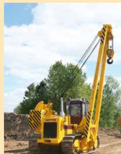
▲ На снимке: трубоукладчик ЧЕТРА ТГ122Я
