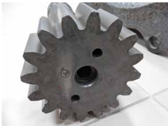
▲ На снимках: солнечная шестерня: оригинал, на котором хорошо просматривается заводское клеймо, и фальсифицированная деталь без клейма
