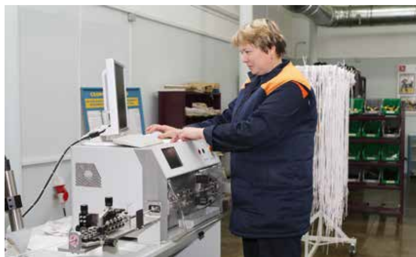
▲ На снимке: обрезка и маркировка жгутов управляется компьютером
