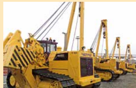
▲ На снимке: трубоукладчик ЧЕТРА ТГ503
