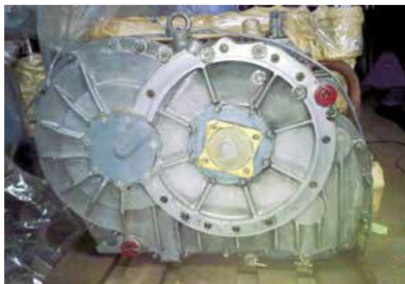
▲ На снимках: низкая качественная термообработка, отсутствие защиты от коррозии, низкая качественная окраска (слева); данная ГМТ восстановлена: на фотографии видно, что номер изделия перебит, такого номера нет в заводской базе (справа)
