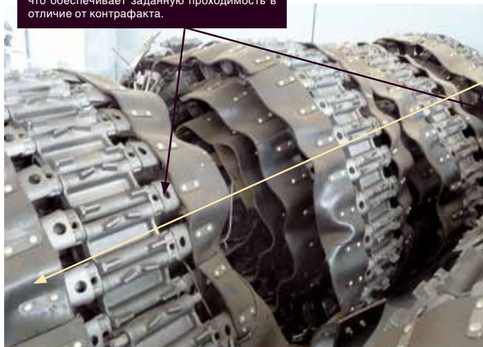
▲ На снимках: оригинал гусеницы на транспортные машины ЧЕТРА (слева); неоригинальная гусеница для машин серии ТМ (справа)
