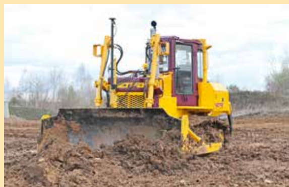
▲ На снимке: бульдозер ЧЕТРА Т9 с системой нивелирования
