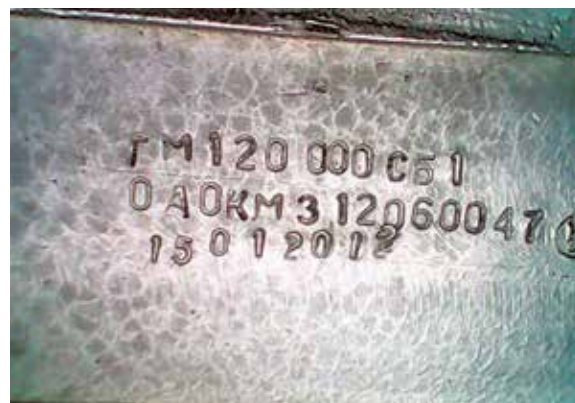
▲ На снимках: низкая качественная термообработка, отсутствие защиты от коррозии, низкая качественная окраска (слева); данная ГМТ восстановлена: на фотографии видно, что номер изделия перебит, такого номера нет в заводской базе (справа)
