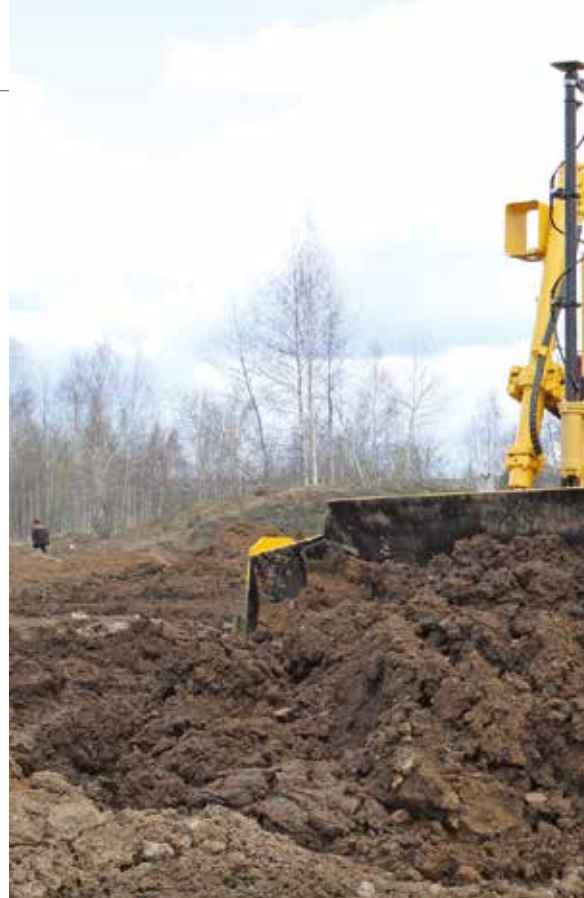
▲ На снимке: бульдозер ЧЕТРА Т9 с системой нивелирования
