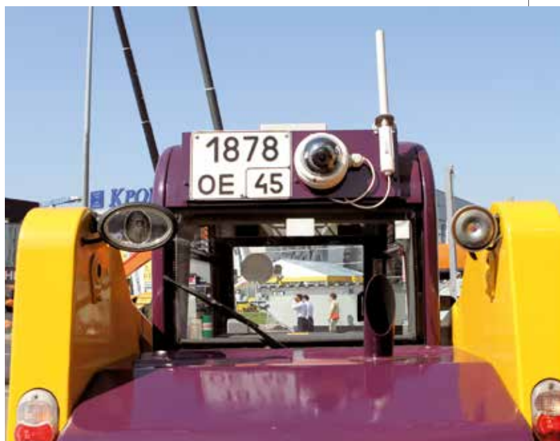
⇨ На снимках: камеры, установленные на мини-погрузчике сзади (вверху) и спереди (внизу), обеспечивают хороший обзор
