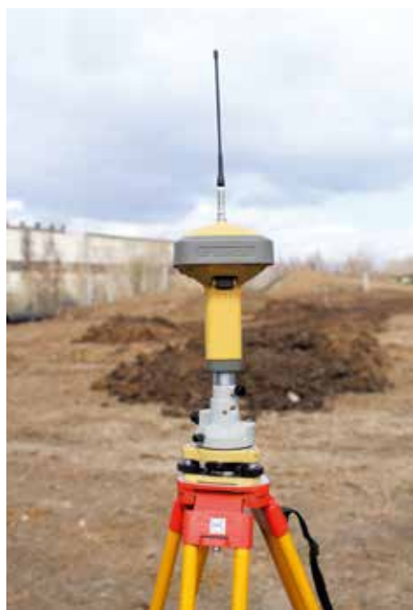
▲ На снимке: передающая антенна
