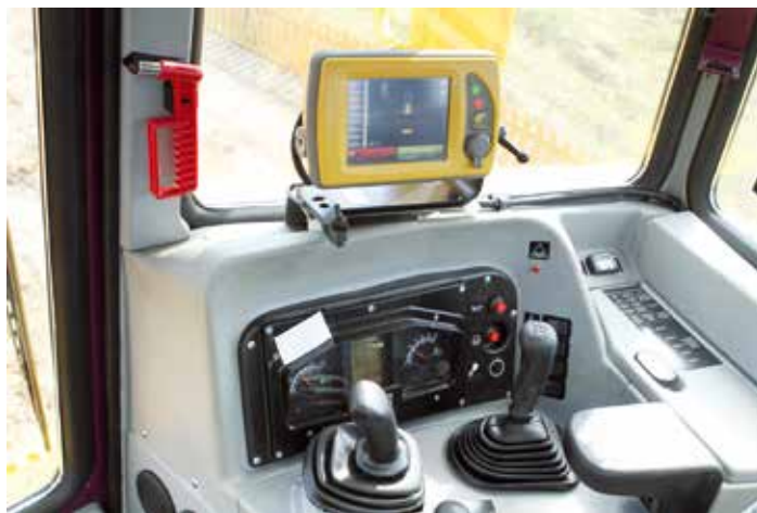
▲ На снимках: кабина бульдозера с установленным монитором; на мониторе отражается точное расположение отвала
