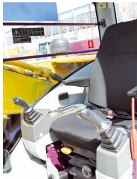
▲ На снимке: подпрессорное кресло с регулировкой под оператора и с джойстиками управления
