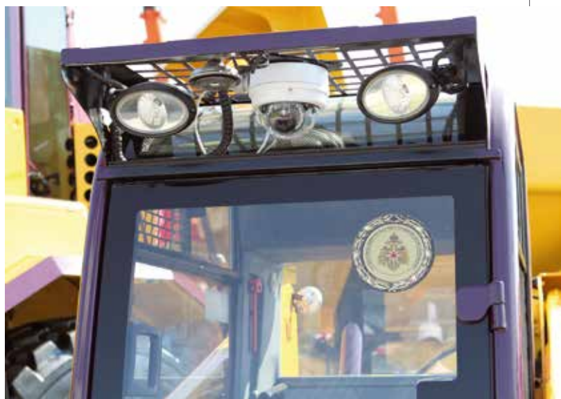
⇨ На снимках: камеры, установленные на мини-погрузчике сзади (вверху) и спереди (внизу), обеспечивают хороший обзор
